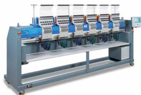
Многоголовочная вышивальная машина универсальная (для вышивки на готовых изделиях) с опускающимся столом ZSK
