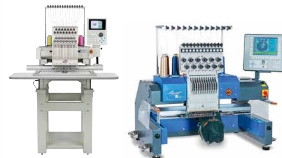
Одноголовочная вышивальная машина с опускающимся столом Tajima (слева) и с неопускающимся столом ZSK (справа)
